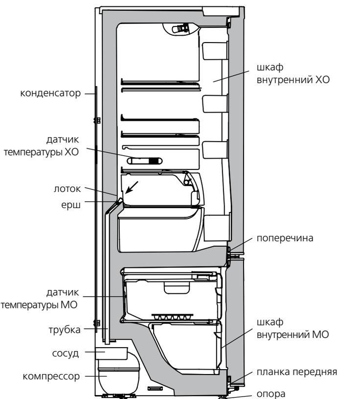
Рисунок 6 — Схема слива талой воды из ХО
